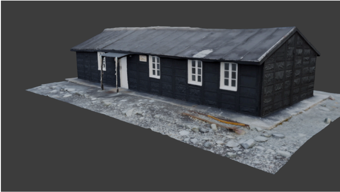
Fig 3. Modelo tridimensional en baja resolución producido a partir de las imágenes tomadas en la campaña.
