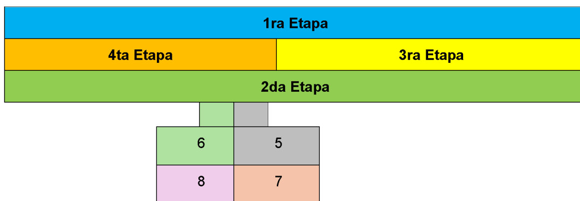
Ilustración 1. Secuencia constructiva de los trabajos a ejecutar.
