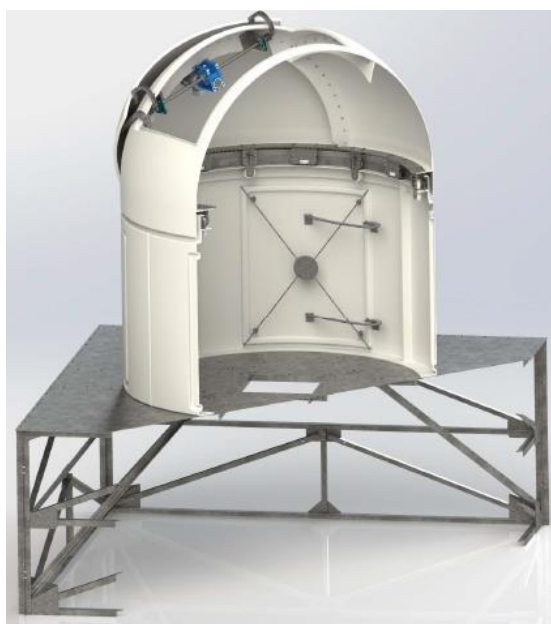
Figura 2: Esquema completo de la cúpula y la base del Observatorio Robótico Antártico Argentino en Base Belgrano II.
