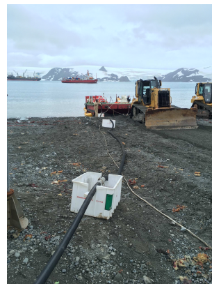
Figuras 5 e 6: Processo de transferência de combustível na Antártica, nos moldes do procedimento adotado pelo Proantar. Barreira de contenção ao redor da chata de combustível na primeira imagem e junção dos mangotes sobre caixa de contenção na segunda imagem.
