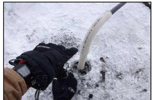
Detalhe 2. Saída da sonda para medição de temperatura.
