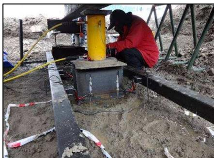
Detalhe: Aplicação de carga no ensaio PLT
