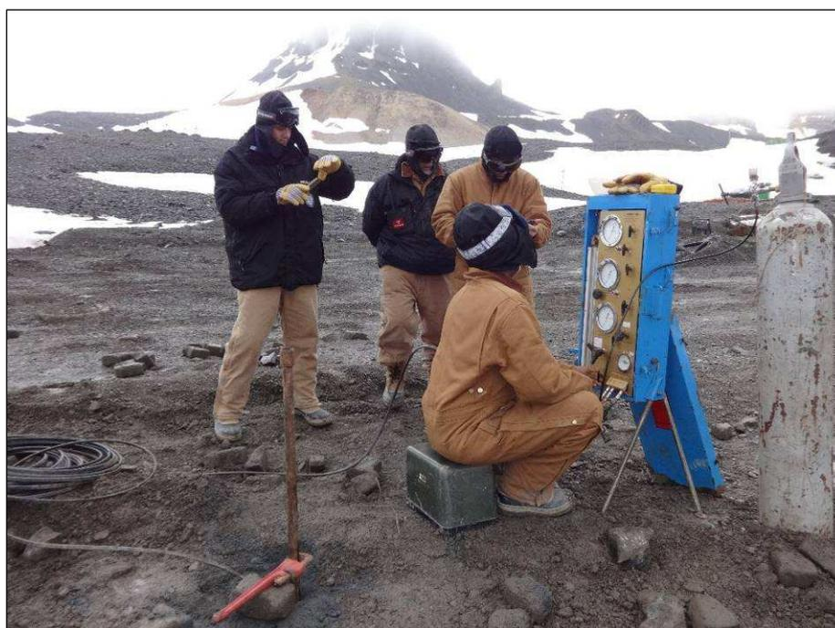
Foto 2. Execução de ensaio pressiométrico.
