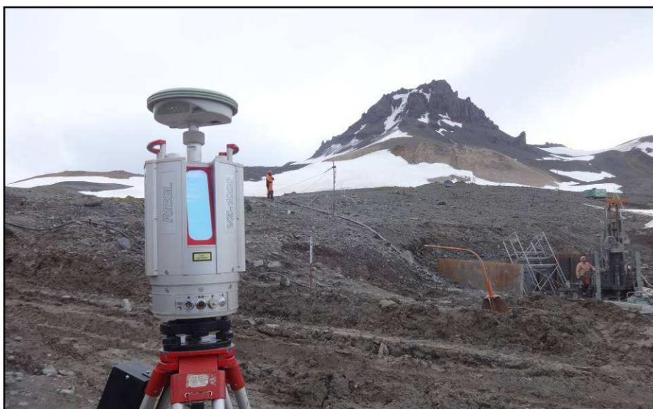
Foto 8. Equipamento laser scanner.
