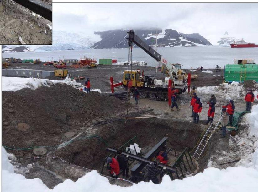
Foto 5. Execução de ensaio de carga em placa sobre o solo de
