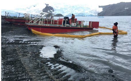
Figuras 5 e 6: Processo de transferência de combustível na Antártica, nos moldes do procedimento adotado pelo Proantar. Barreira de contenção ao redor da chata de combustível na primeira imagem e junção dos mangotes sobre caixa de contenção na segunda imagem.
