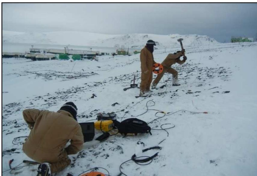
Foto 4. Método geofísico de investigação do subsolo: MASW.
