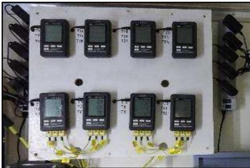
Detalhe 1. Sistema de aquisição de dados (temperaturas).
