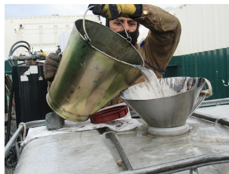
Figuras 7 e 8: Local para manutenção de maquinários e equipamentos (garajão) e processo de abastecimento de maquinário com auxílio de manta absorvente de óleo para evitar vazamento para o ambiente.
