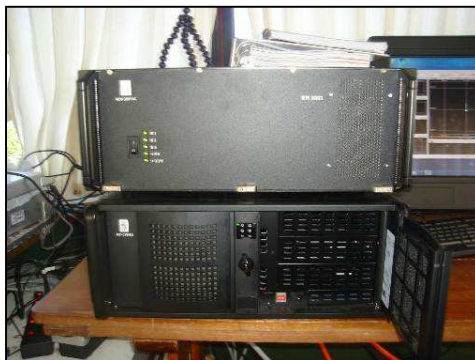
Estación de trabajo Sistema Multihaz Kongsberg EM 3002D
