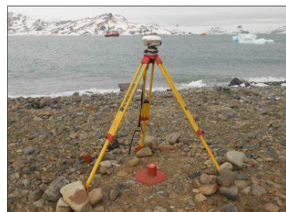
DGPS Trimble R8 Rover N° 0220390447
