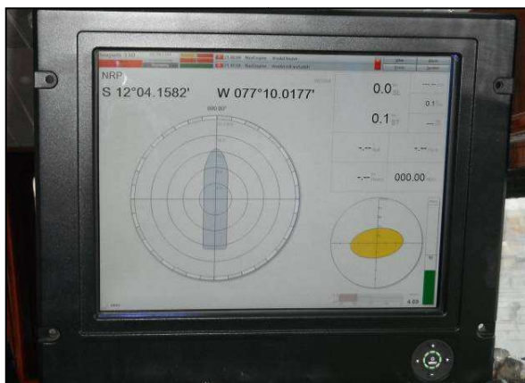
Sistema de posicionamiento SEAPATH 330
