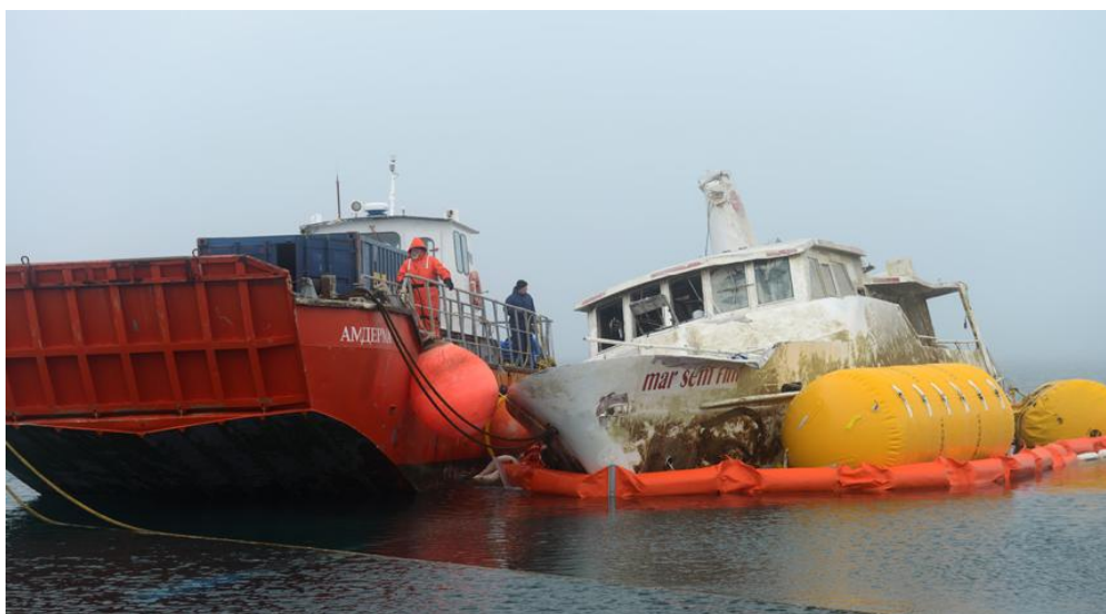
Trabalho de reflutuação da embarcação “Mar Sem Fim” (Fonte: www.marsemfim.com.br )
