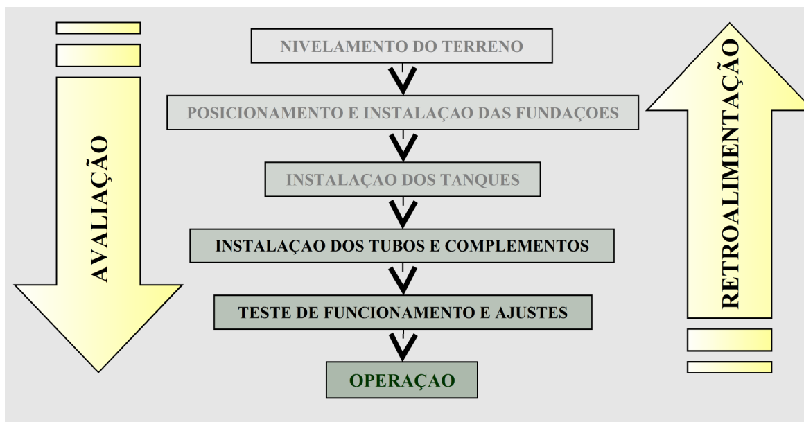
Figura 8 – Esquema básico de instalação dos tanques.
