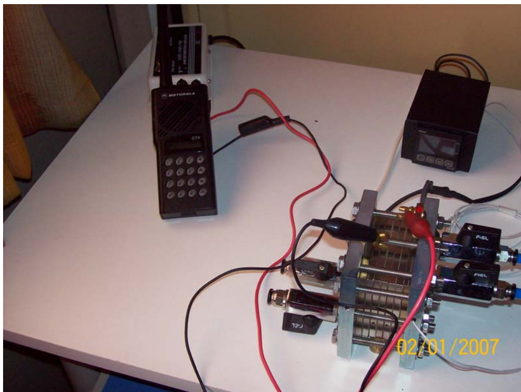
Carga: Handie Motorola de 6 Volts, que funcionó correctamente en modo recepción
