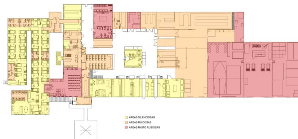
Figura 6 – Zoneamento Acústico (conceitual) de distribuição das áreas de acordo com o nível de pressão sonora previsto no arranjo do Plano Diretor.
